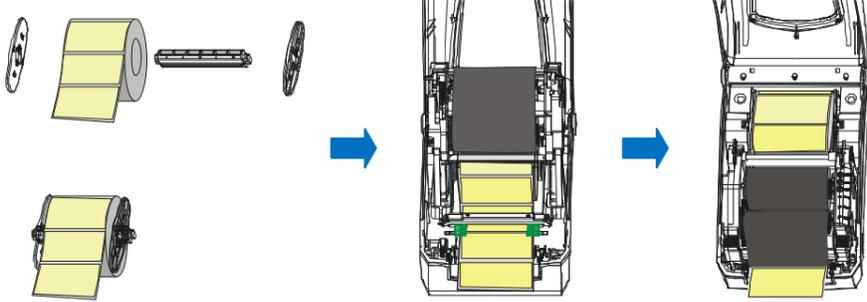
1) 把纸卷套入纸卷轴，将两个纸卷挡板从两边套入纸卷轴，光滑面朝向纸卷。
